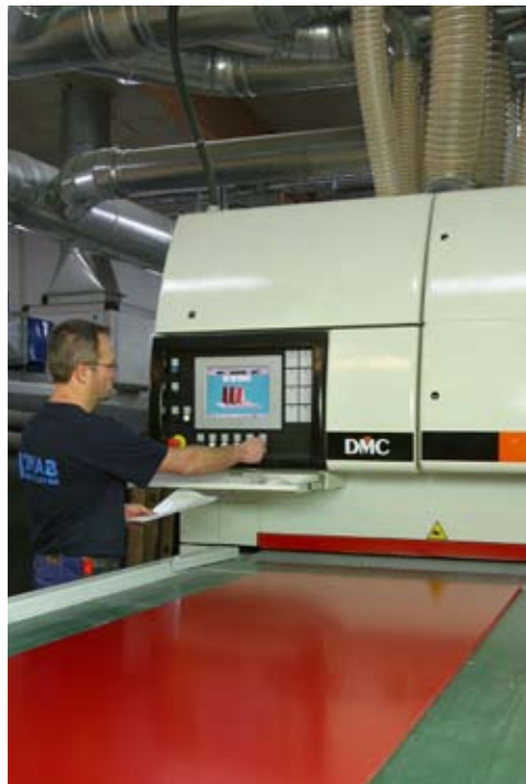
Datorstyrd produktionslina för ytbehandling av väggelement.
